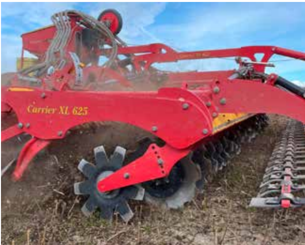
En Carrier XL 625 är både jordbearbetare och såmaskin för höstraps och mellangrödor hos Bertil Hagsgård.
