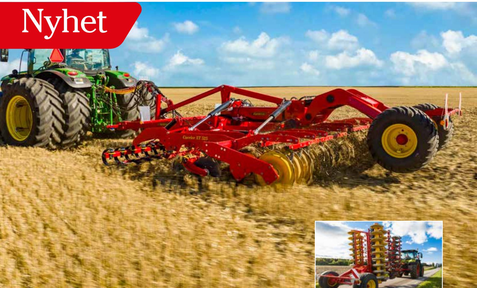
Den bogserade Carrier XT är certifierad för 40 km/h i vägtransport.
