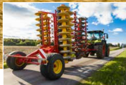
Den bogserade Carrier XT är certifierad för 40 km/h i vägtransport.
