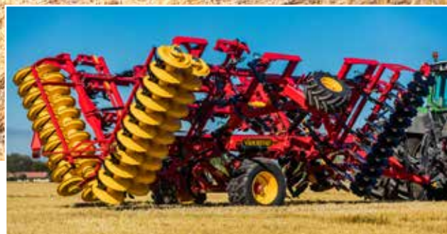
TopDown 400-700 fälls ihop till 3 meters transportbredd.
