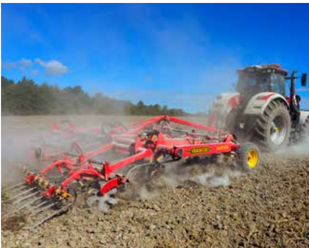
Swift brukar ner kalk i september 2022 inför höstvetesådd, men maskinen uppskattar Bertil Hagsgård för att den också gör en bra höstjämning inför vårsådd. Traktorn är utrustad med automatisk tryckluftsreglering.
