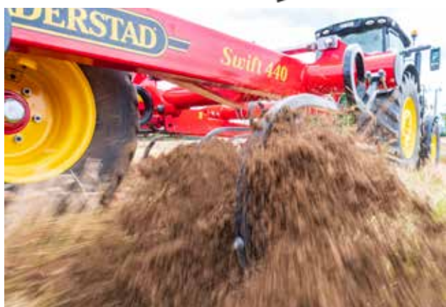
De vibrerande Swift-pinnarna ger en intensiv inblandning ner till 20 cm arbetsdjup.
