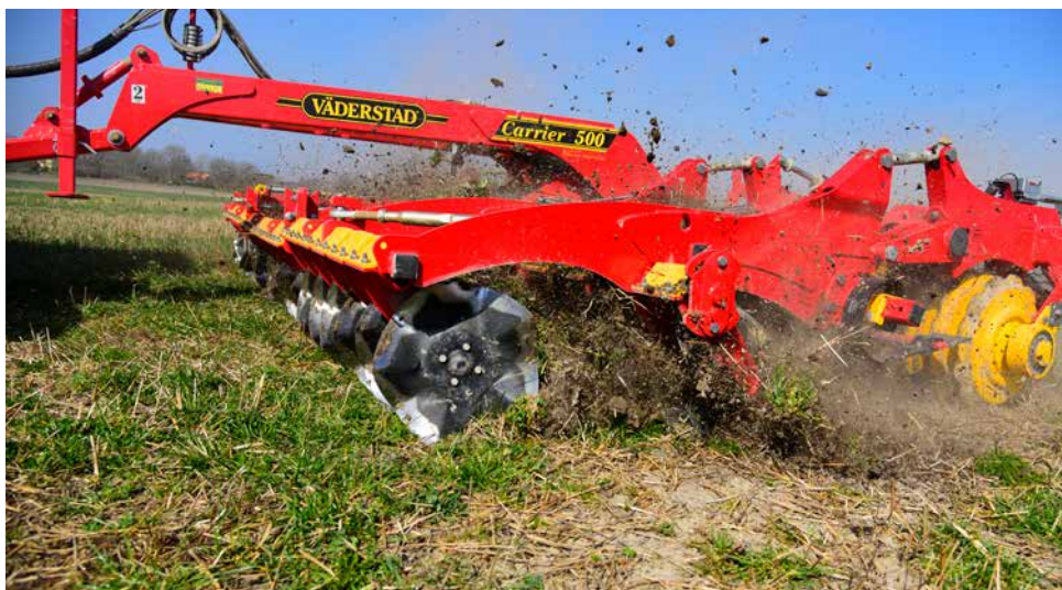
Tobias körde upp utvintrad höstraps med sin Carrier våren 2018 med tallrikarna på 2–3 cm djup och i 15 km/h. Det fungerade väl. Här arbetar maskinen på en grönträda.
