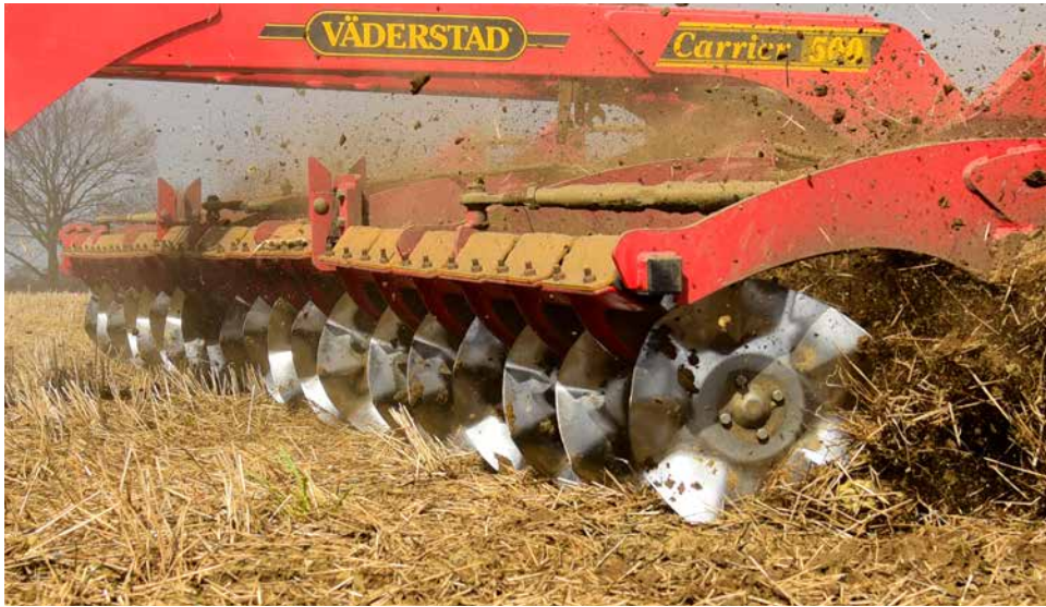
CrossCutter Disc på en Carrier är ett effektivt sätt att upprepade gånger skapa en falsk såbädd för att locka ogräsfrön att gro.
