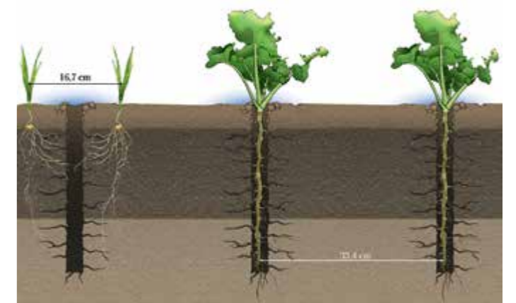
Сівалка для смугового обробітку і сівби Spirit C StripDrill здатна забезпечити висів зернових культур з міжряддям 16,7 см, ріпаку з міжряддям 33,4 см
