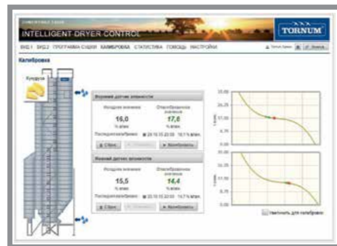
^ Система дозволяє проводити контроль при значній різниці вологості зерна на вході в сушарку. В якості прикладу наведено таблицю вибору мінімального діапазону коливань вологості залежно від значення на вході та % її зняття
