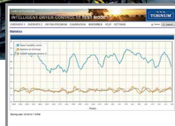
▲ Статистика значень вологості зерна та температур під час сушіння протягом всього сезону зображена в спеціальному меню Statistics
