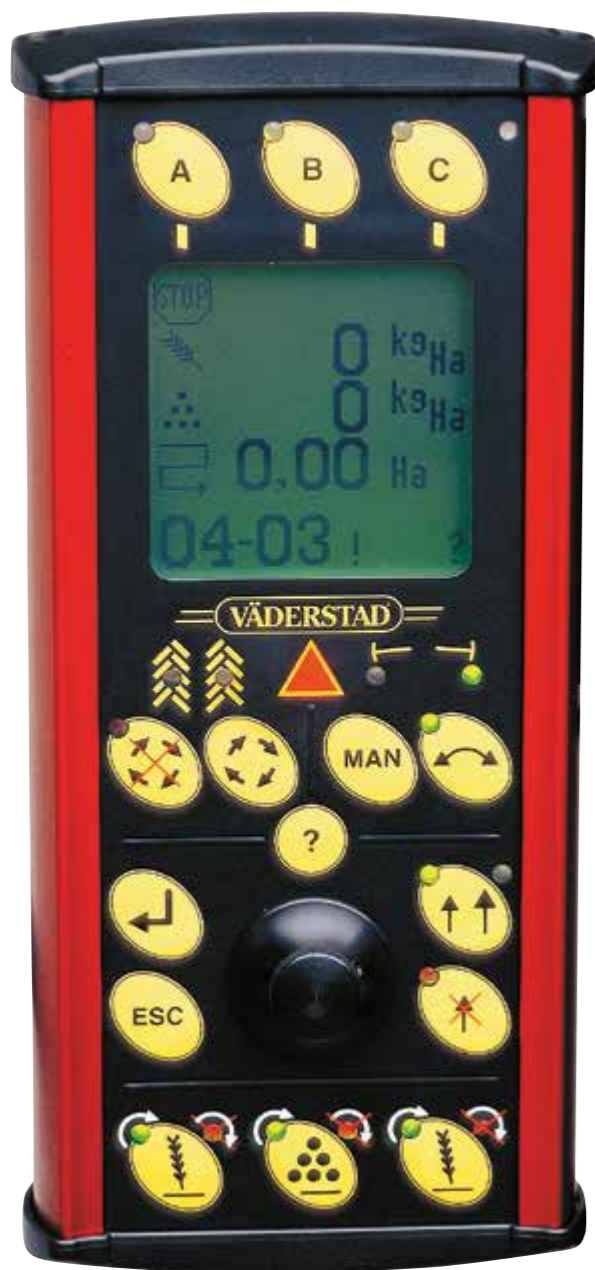
^ Пульт управління сівалки в кабіні трактора показує засіяну площу, оберти вентилятора, норму висіву та оберти висівної котушки
