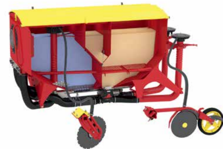
Місткий бункер об'ємом 5000 л для завантаження насіння та добрив. За необхідності можна легко відрегулювати необхідне співвідношення об'ємів завдяки рухомій перегородці всередині бункера
