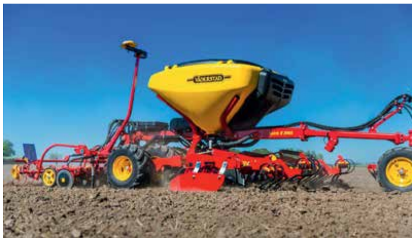
^ Нова форма дисків сошників на всіх моделях сівалок Spirit з гострішим робочим кутом для більш точного і якісного проникнення в ґрунт на задану глибину
