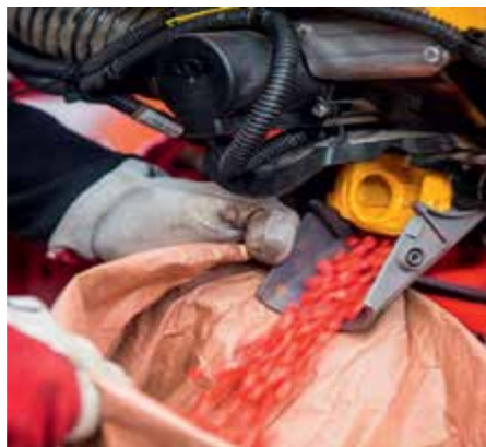
← Алюмінієвий корпус висівного пристрою
