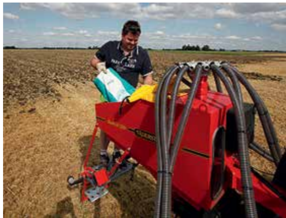
^ Насінневий бункер міні-сівалки BioDrill має об'єм 360 л
