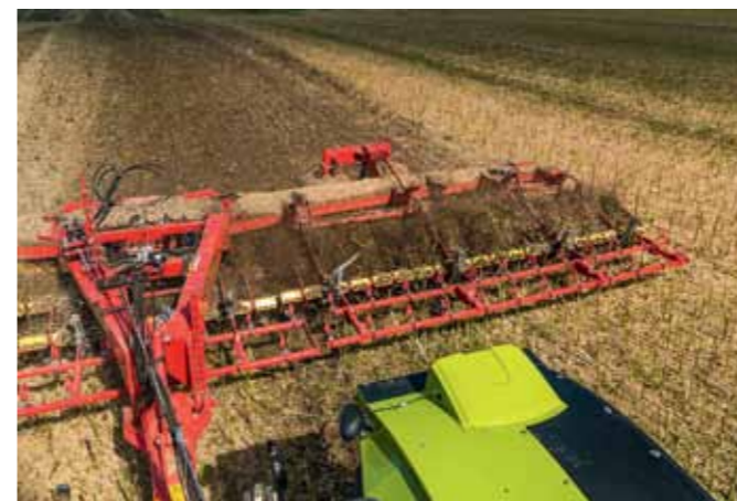
Робота по стерні ріпаку дискового культиватора Carrier, обладнаного ножовими дисками CrossCutter Disc
