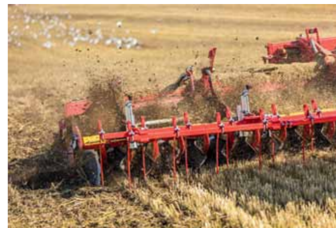
Робота по стерні зернових дискового культиватора Carrier, обладнаного ножовими дисками CrossCutter Disc
