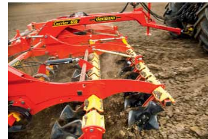
Робота ножових дисків CrossCutter Disc по оранці
